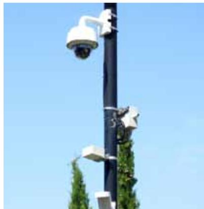
Une caméra motorisée équipée d'un détecteur SENSIVIC en situation réelle
